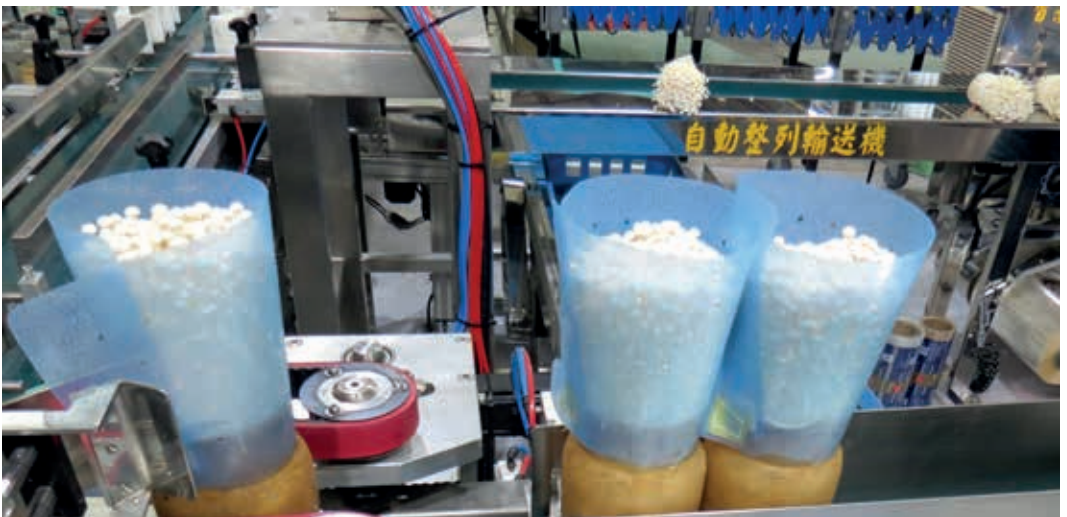
圖4. 農試所金針菇塑形護膜裝置
