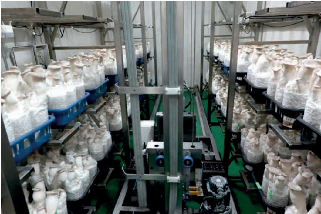
圖2. 農試所菇苔自動上下架系統
