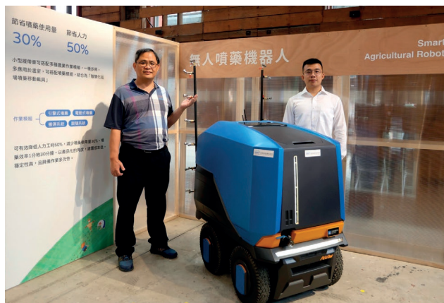
圖1. 工研院無人噴藥機器人結合戶外即時動態定位、光偵測、車載資訊進行導航，20分鐘內可完成一分地的精準噴藥，安全高效又可節省人力50%。
