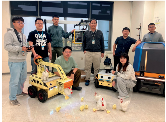
圖2. 工研院禽舍管理巡檢機器人如同全日保姆，整合自動排程、視覺與導航模組，即時掌握雞群健康，避免人員頻繁進出汙染來進行最有效率的管理。
