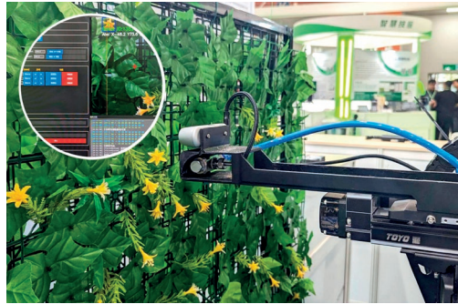
圖3. 除了人工與熊蜂，工研院提供的空氣擾動授粉機器人結合影像辨識、導航與簡易滑軌控制，可精準即時進行授粉作業，已與高雄區農改場進行合作驗證。
