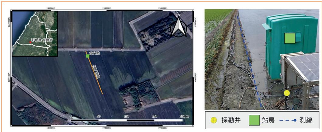
圖 2. 竹塘試驗區位置與地電阻儀架設圖。
