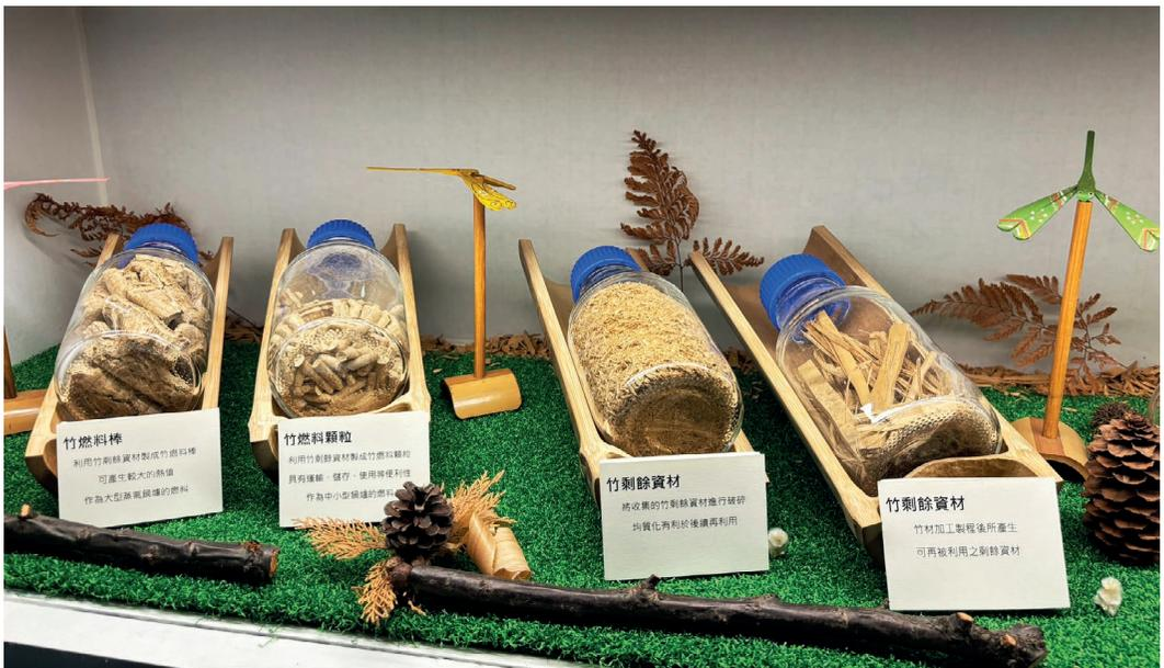
圖5. 竹類剩餘資材製作竹質生質燃料。
