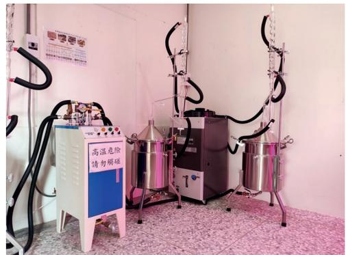
圖2. 研發團隊所研發出「優化傳統水蒸氣萃取技術」套組。
