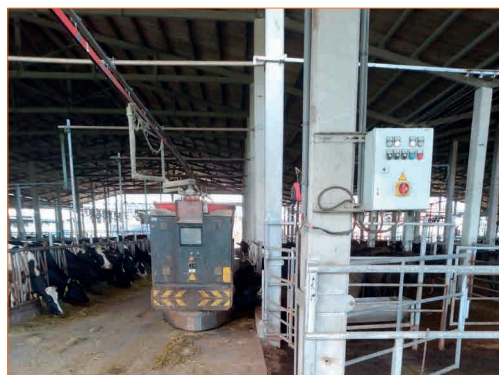
圖 7. 全自動自走式餵料機定時自動送到特定欄位給特定的牛群吃。
