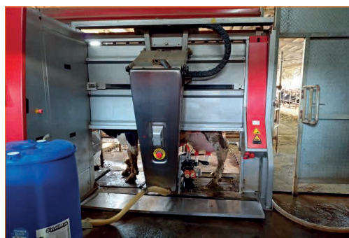
圖 8. 全自動擠乳機器人自動幫牛清潔乳頭，套好擠乳杯自動進行擠乳。
