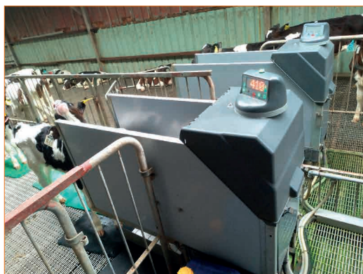
圖2. 小牛自動餵乳站自動辨識小牛編號。
