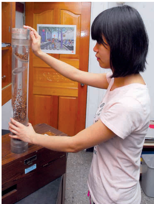
圖3. 細小質輕的種子可用風選機來篩選汰除輕粒與雜質。
