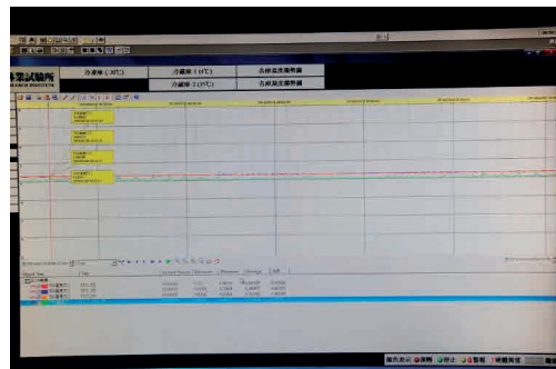
圖 2. 林試所種子冷藏庫之電腦溫控系統, 可隨時繪出溫度曲線。
