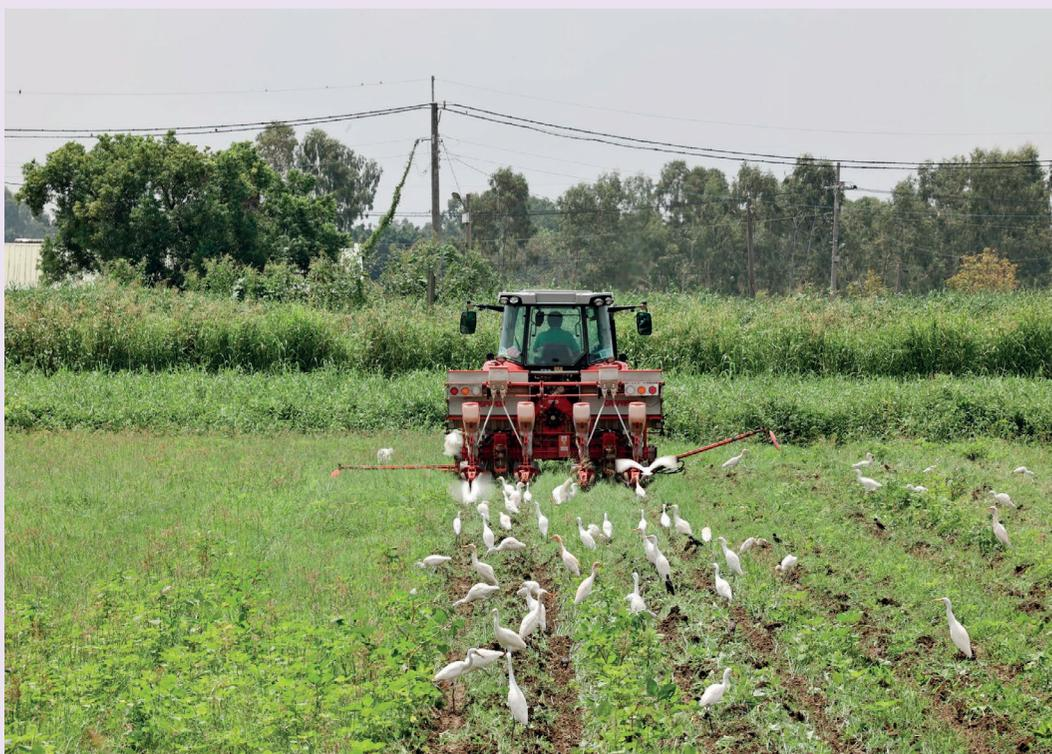
玉米不整地栽培作業機，除真空點播種外，兼具施肥和殺蟲劑條施作業。同時可利用雜草或上季剩餘的生物質進行敷蓋，降低土壤水分蒸發，夠多的生物質除可避免雜草的蔓生，建構適合種子發芽的土壤環境。
