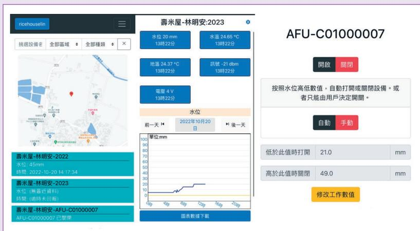
使用者透過行動裝置，可即時觀看田間水位感測器與水源控制設備的運作情形，並隨時進行遠端遙控。
