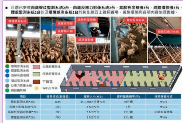
建立肉雞物聯網感測系統架構。
