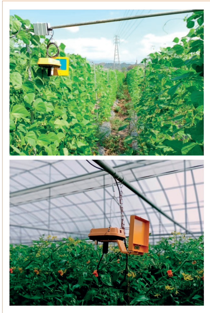
圖5. I 2 PDM 智慧病蟲害監測系統布建於作物栽培現場之情形。
