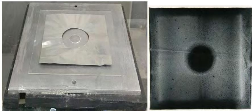
圖十 新式多電極紡絲架構圖，紡絲圖案化奈米纖維。
