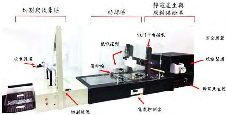
圖三 自動化奈微米靜電紡絲量產機構設備示意圖。
