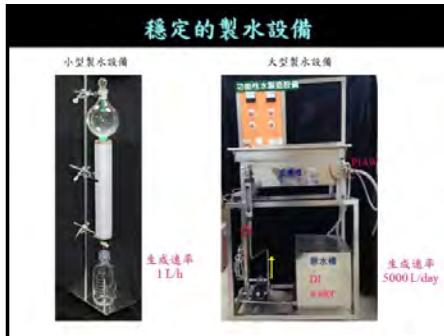
圖 1. 成功開發性質穩定，可做實驗、可量產電漿活化水設備(每天 6 公噸)
