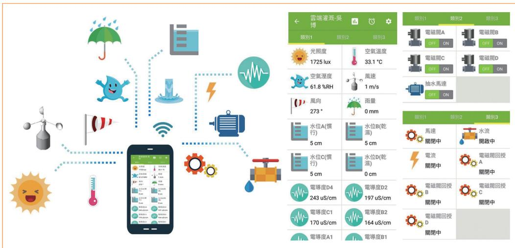
圖3. 透過資通訊鏈結田間感測器訊號，即時監測田間現況及管控用水。
