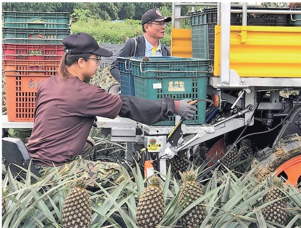
圖3. 手煞車連動裝置進行煞車作業過程。
