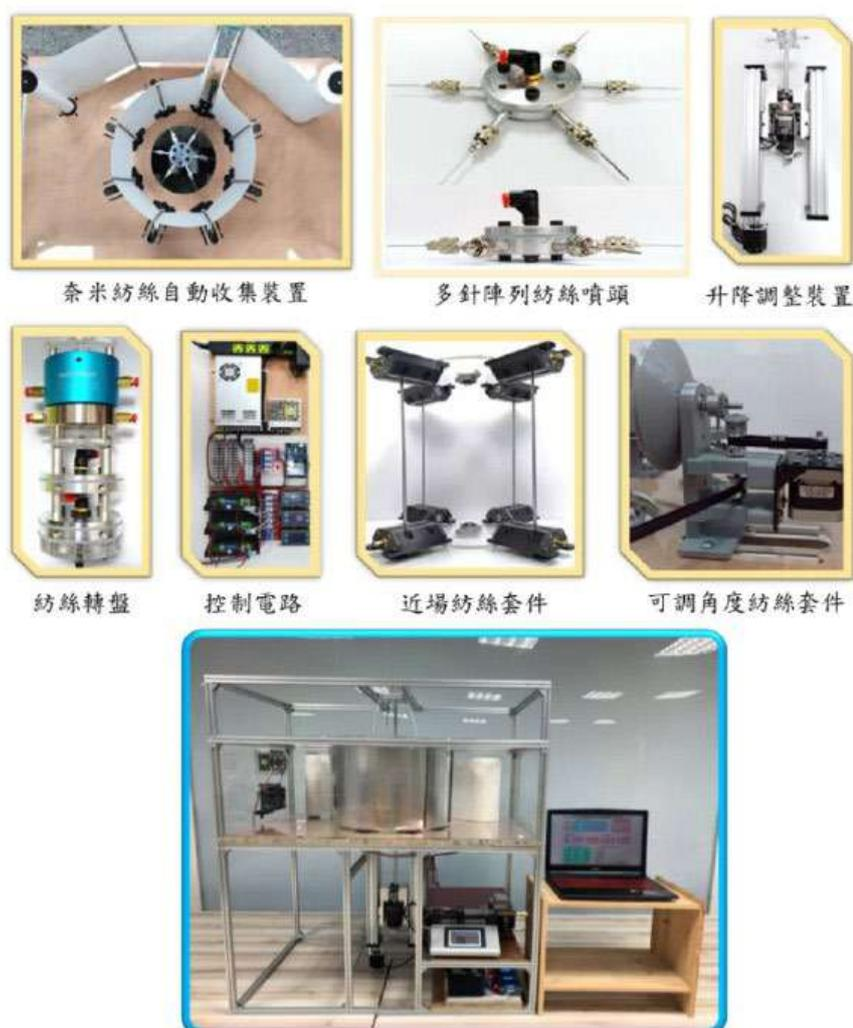
圖 1. 自動化蠶絲奈米化生產設備和系統功能架構
