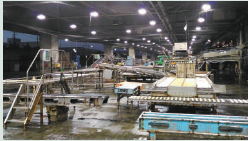
長崎魚市場開發鯖鱈圍網冰藏漁獲用7級選別機與輸送帶之組成機具。
