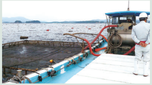
日本黑瀨水產株式會社之海上箱網養殖餵飼專用船上之雙管機械自動計量投餌機。
