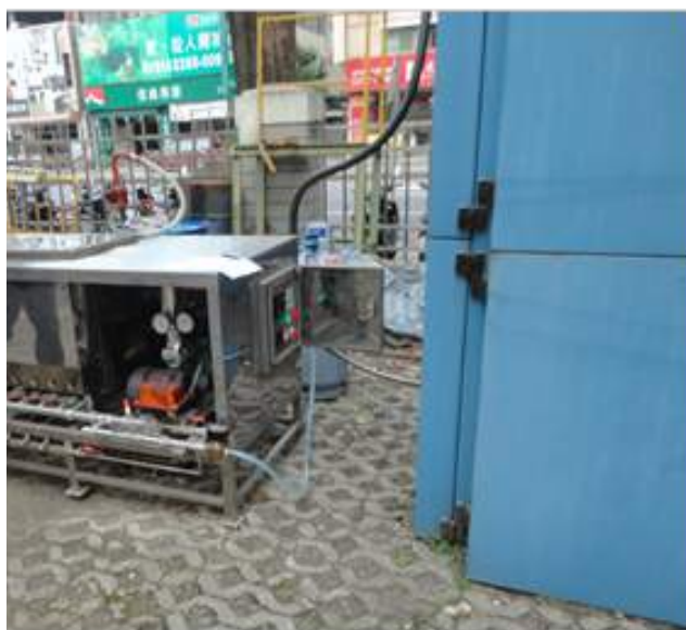
熱媒油外部加熱器與高溫反應槽之連結安裝及運轉測試
