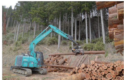
高性能造材處理機有打枝、量測材積、造材鋸切、夾取原木整理、整地等多項功能。
