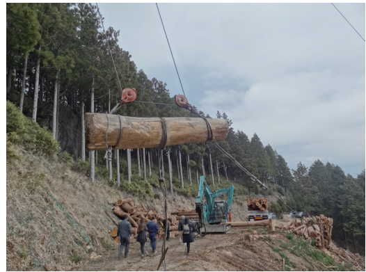
集運現場所使用架線集材為泰勒循環式架線，透過集材機操控鋼索，搬器可在主索上搬運原木。
