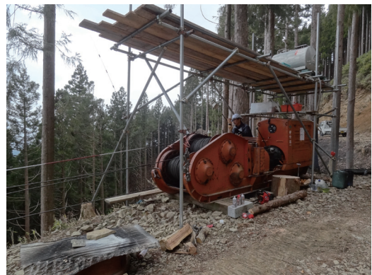
油壓高效率三胴集材機體積小，易於搬動移位。
