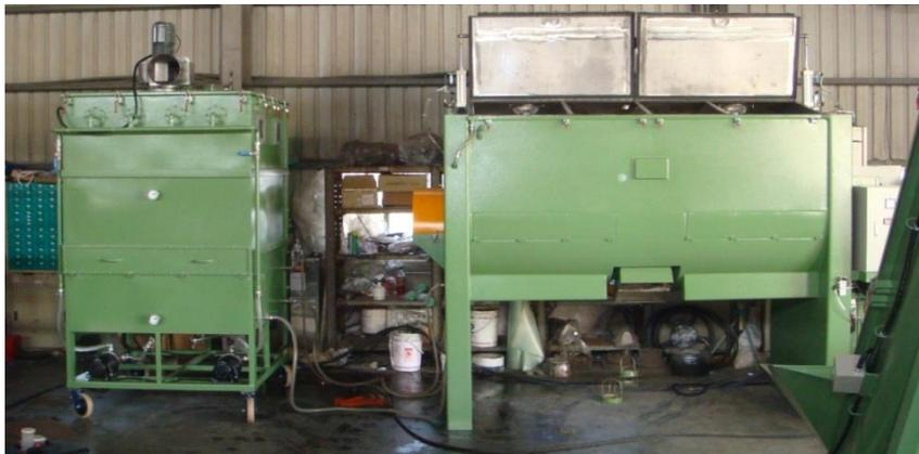
圖 4、快速處理之卡車可載運移動密閉式 3m<sup>3</sup> 反應槽(右)及除臭系統(左)之設備
