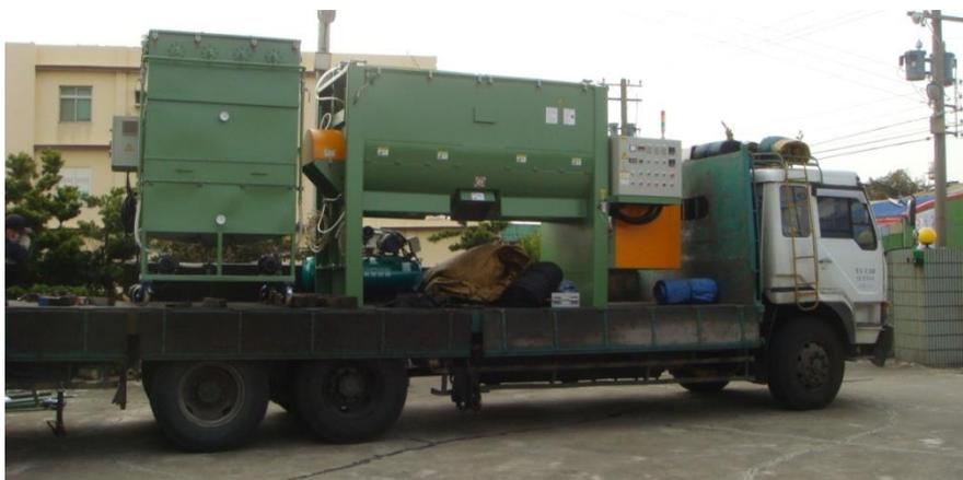
圖 5、完成卡車可載運移動密閉式反應槽及驗收
