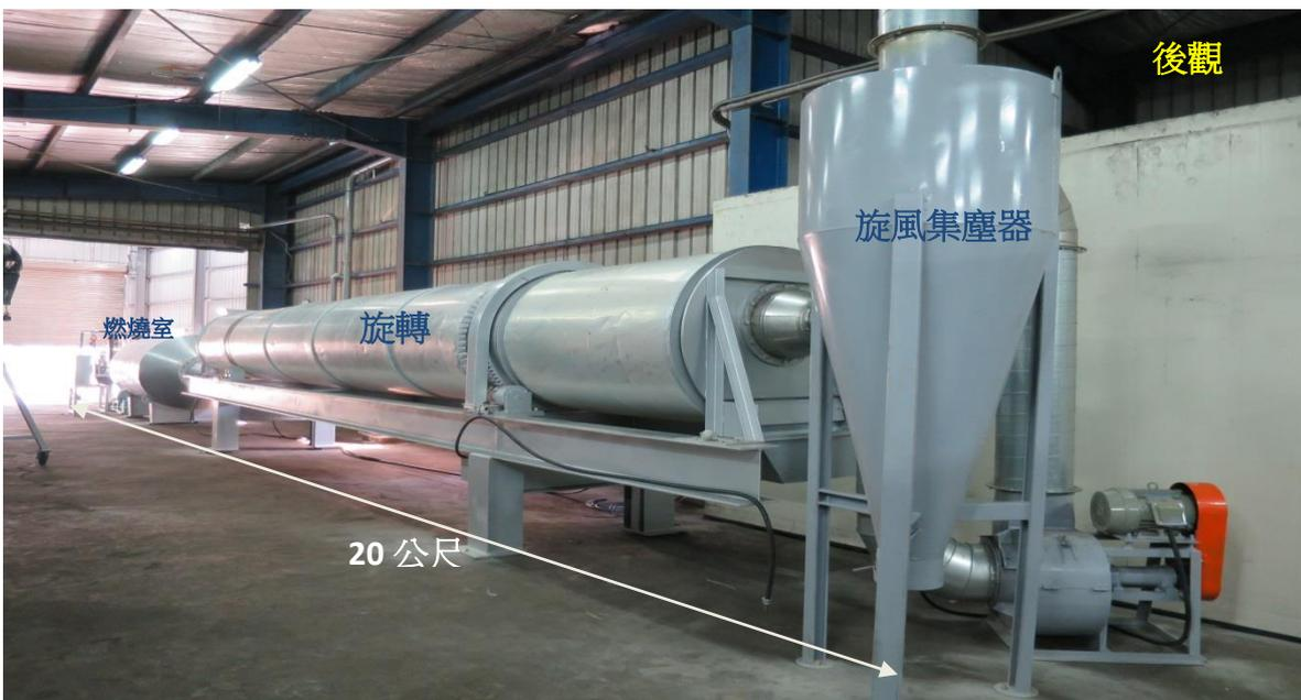
圖8、連續式高效氣化爐節能烘乾機之前觀及後觀
