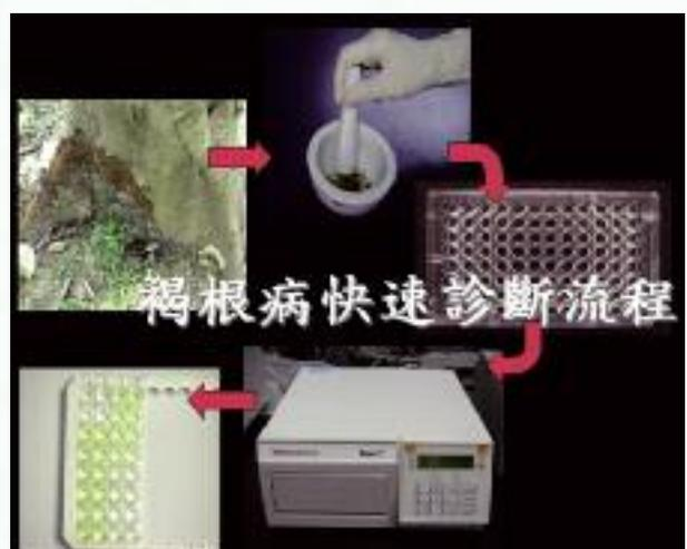
圖四、單元抗體免疫酵素反應應用在褐根病快速診斷之流程。
