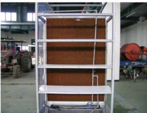
水簾降溫及加濕裝置
