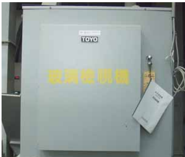
新設備能有效將未成熟米、有色米及石粒、玻璃等雜質剔除，提昇米的加工品質。
