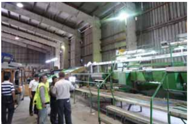
Leader Brand公司的接待員解說大型瓜果清洗分級機之操作情形
