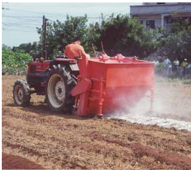
曳引機附掛蔬菜園有機肥施肥器承載0.4立方公尺有機肥儲放桶，具有多種施肥方式，視其作業需要而調整，若採左、中、右三段全開全寬度撒佈時，可用於農地耕耘整地前使用。
