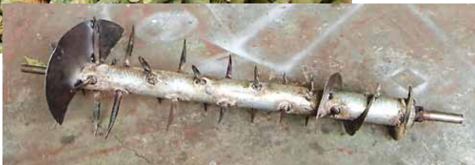
圖二．蓮子剝蓮蓬機剝蓮蓬滾筒示意圖
