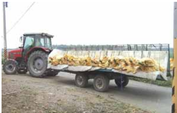
圖五 採收搬運車由曳引機與拖車連結而成，可減少果把擦壓傷，並達省工目的。
