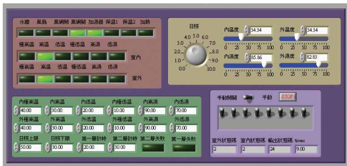
以LabVIEW圖控式語言撰寫溫室環境操作人機介面視窗 (模型溫室控制面板)
