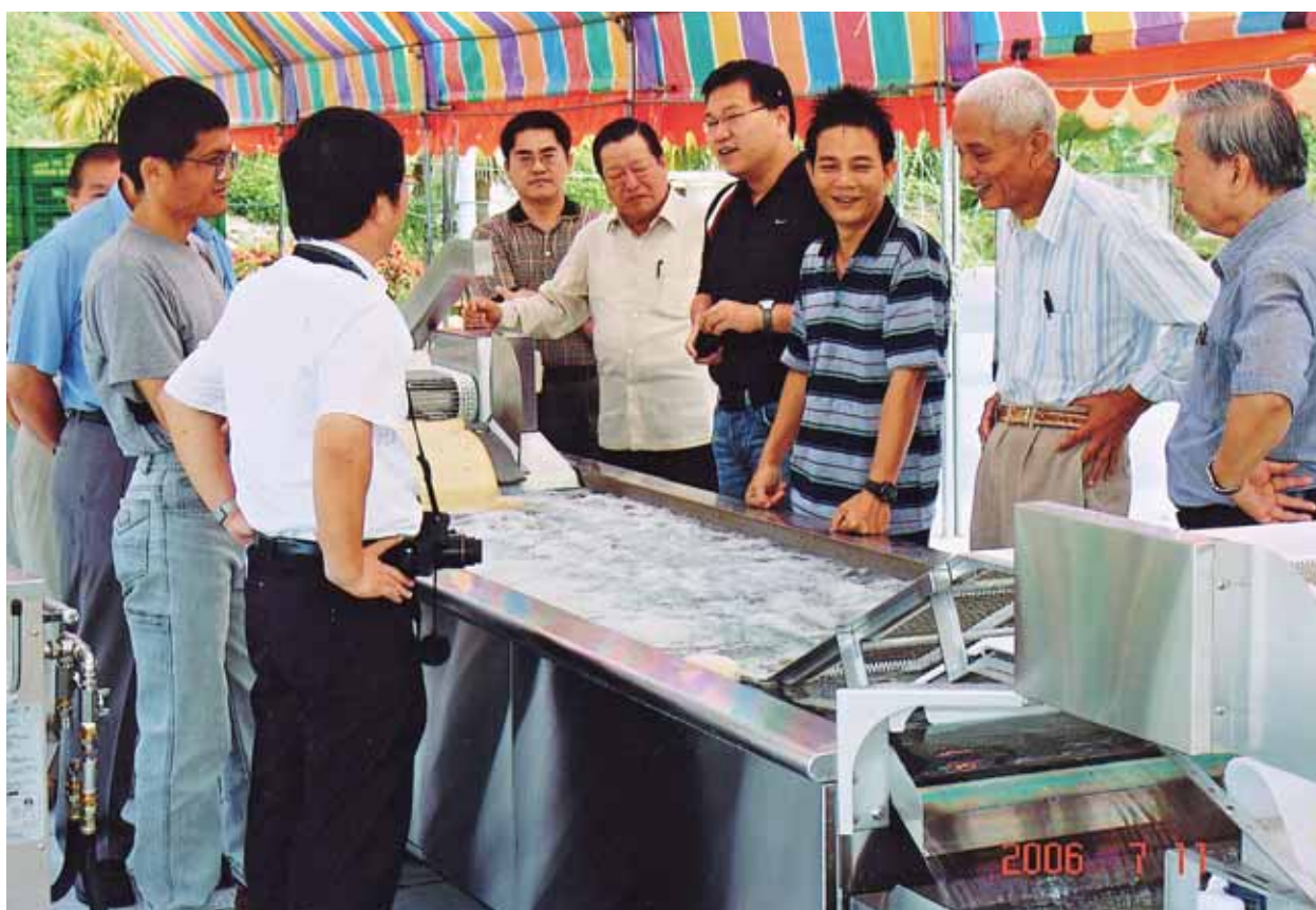
本基金會陳執行長率研究小組參觀杜普公司蒸熱廠外銷日本檬果處理情形，圖為檬果超音波清洗機。
