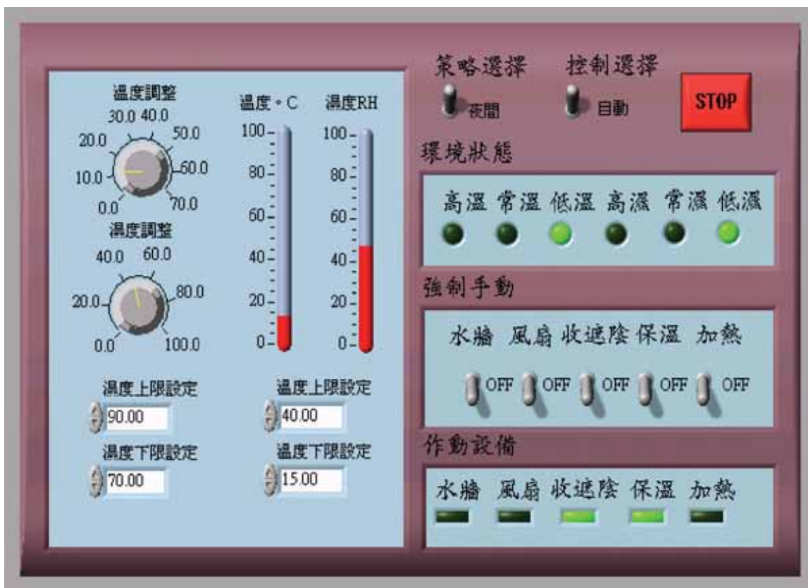
以LabVIEW圖控式語言撰寫溫室環控操作人機介面視窗(人為輸入-直覺控制法程式顯示畫面)
