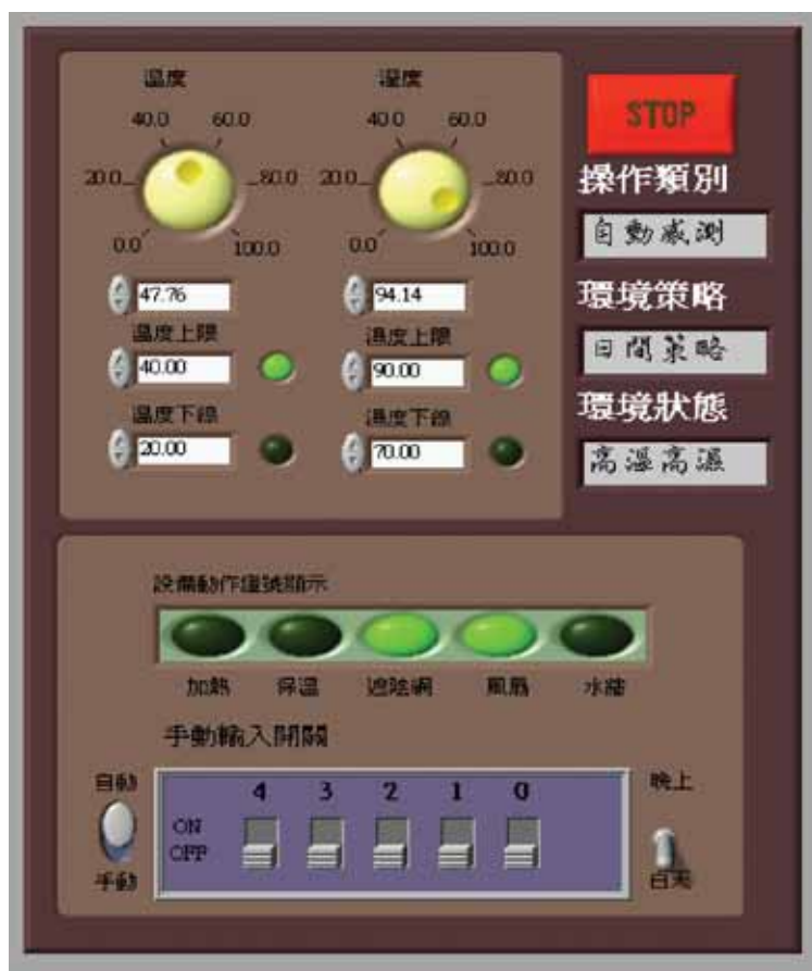
以LabVIEW圖控式語言撰寫溫室環境操作人機介面視窗 (人為輸入-數碼迴圈控制面板)
