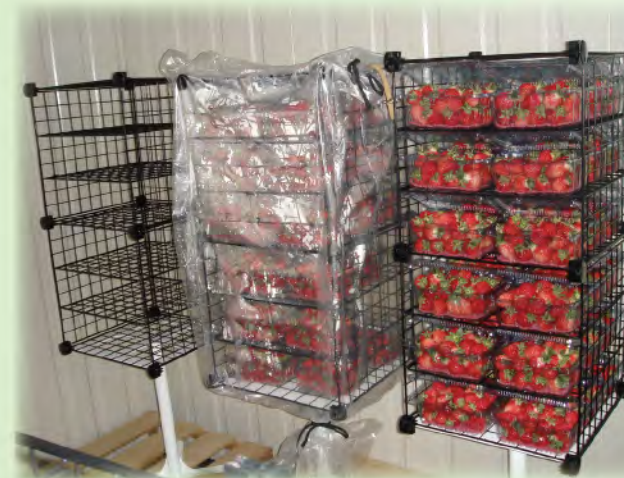
草莓貯藏試驗：左為試驗用貯藏框架，右為框架上置放草莓貯藏，中為大塑膠袋加 CO 2 氣變貯藏
