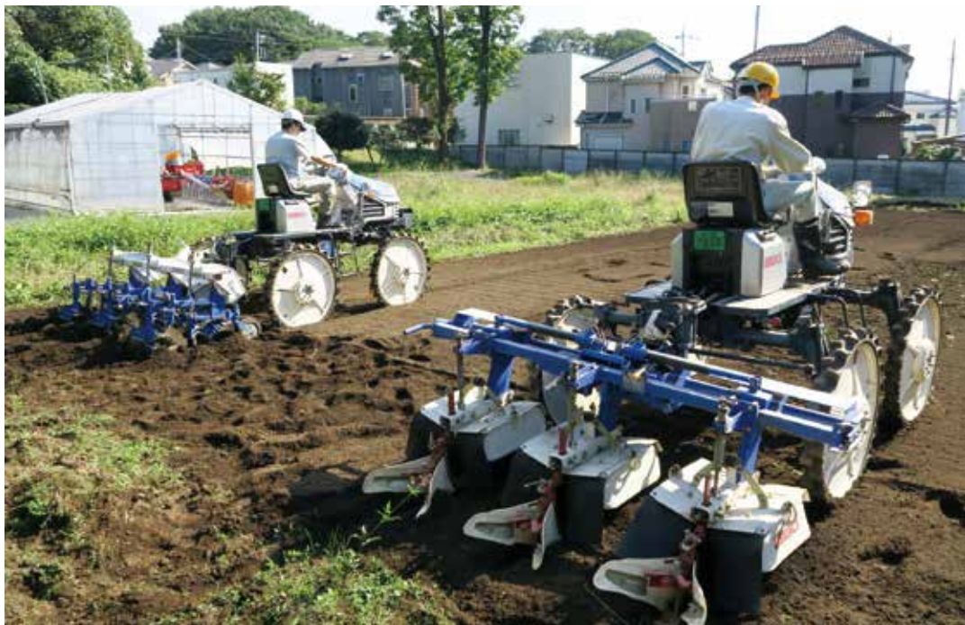
耕犁型及耕刀細碎型二種乘坐式除草機。
