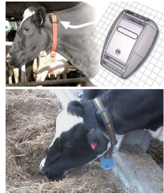
反芻監控系統為掛於牛隻頸部之電子盒，內嵌有移動感測器及微型麥克風
