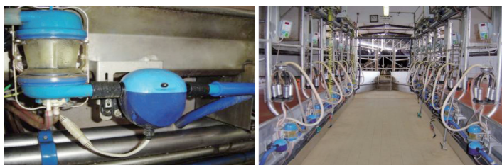
擠乳線上即時乳質分析器及其在擠乳間擠乳系統之配置
