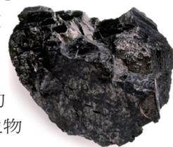
生物碳會因製作條件不同而產生極大不同的特性。生物碳可以幫助改善黏質土壤的排水變好，幫助砂質土壤改善保水力，但不正確的製作生物碳會損害土壤而不是改善。研究發現在低於 450 °C 所生產的生物碳會保留一些有機化合物，導致水分控制能力差。且生物碳的碳庫不穩定，明顯有多數的碳於幾百年內即返回大氣中。Masiello 研究團隊計畫如何優化生物碳的其他效益，包括移除重金屬以及其他土地污染的能力，並發表操作手冊，精準顯示生產最優良的生物碳所需要的條件。
