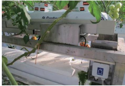
圖6 Tomato World展示溫室中用來計算滴灌量及水分逕流率的測量裝置。
