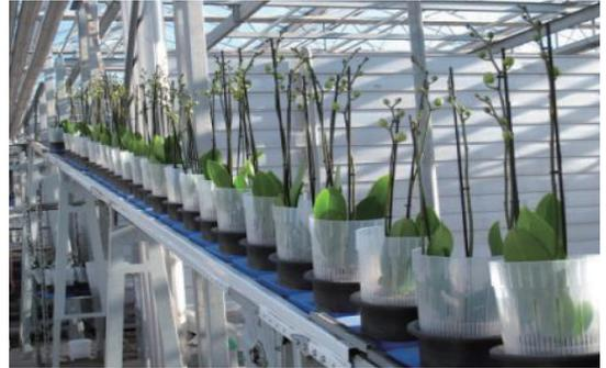
圖2 Kwekerij Piet Vijverberg 經過影像處理分別後的蝴蝶蘭由軌道運送至溫室，盆子下方藍色塑膠片內有電子標籤，可以RFID系統讀取。
