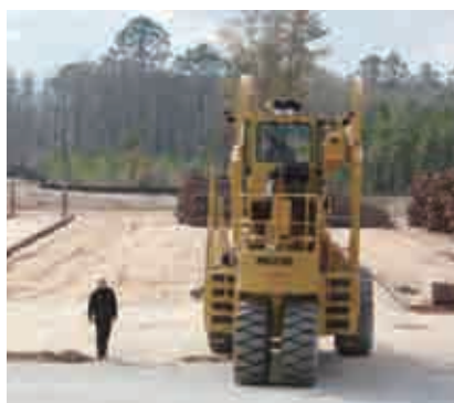
圖5. 古董級的Wagner原木堆疊機(log stacker)
