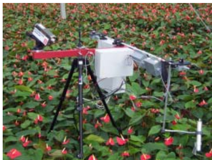
圖 3、植物生理線上監測系統實際運作情形
