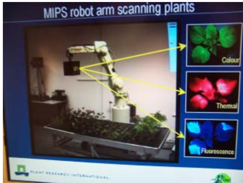
圖 1、配合機器手臂做 3D 取像，並以影像處理技術監測分析植物的生理狀況
