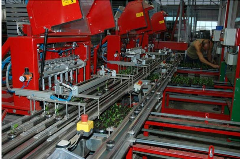
圖 11. 白鶴芋換盆機。苗取出後先分成 4 級再上盆，每小時每人移植 8000~10000 盆。
