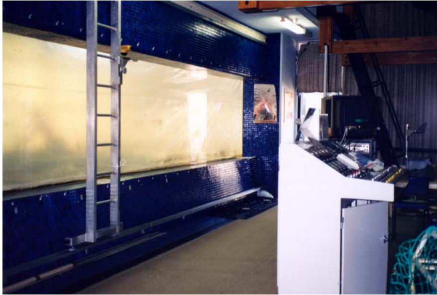
照片一、澳洲海事學院(AMC)之矩型環流水槽(Flume Tank)
